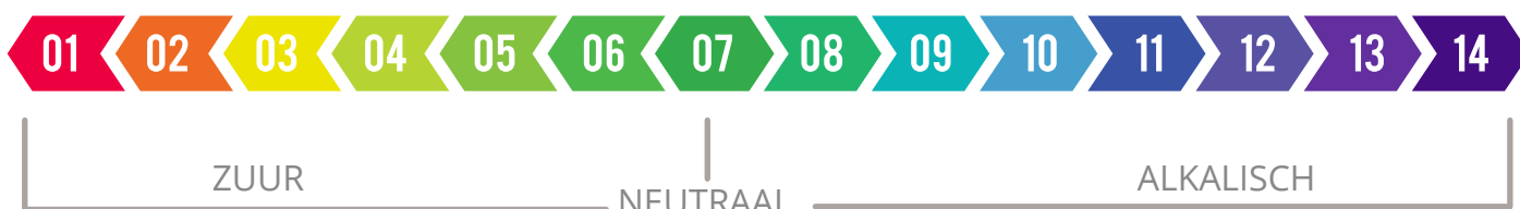
Figuur 2: PH schaal. Zure reinigingsmiddelen vallen onder de pH waarde van 6 of lager. Neutrale reinigingsmiddelen hebben een pH waarde van 7. Alles boven een pHwaarde van 7 is Alkalisch.
